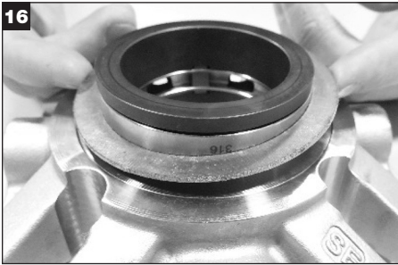
16 Retire la junta para quitarla del adaptador y deséchela.
