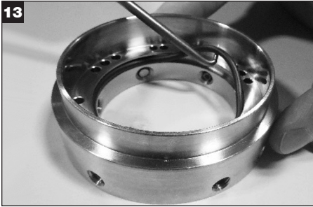
13 Retire el O-Ring del anillo de bloqueo (Y) y deséchelo.
