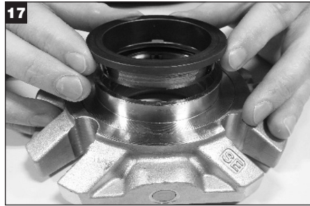
17 Retire el anillo estacionario del sello interno para quitarlo de la brida y deséchelo.
